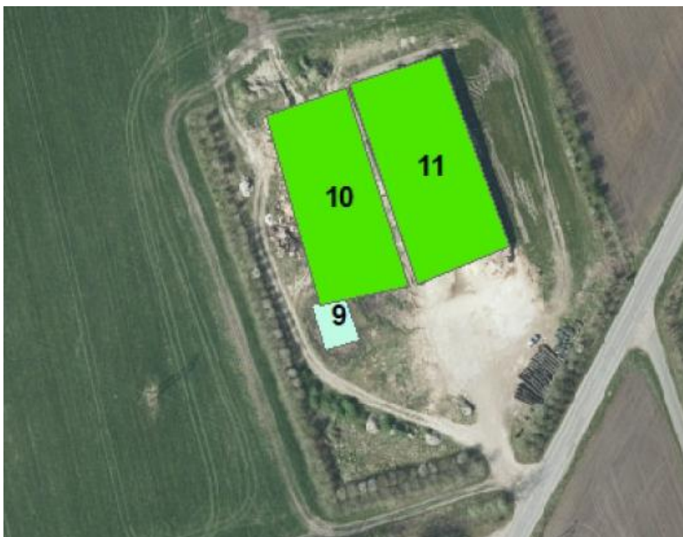
Figur 1: Placering af affaldsforbrændingslagge. Der er allerede plansiloer i byggefelt 11. De nye plansiloer etableres i byggefelt 10. Luftfoto fra miljøgodkendelsen til udvidelse af husdyrbruget.
